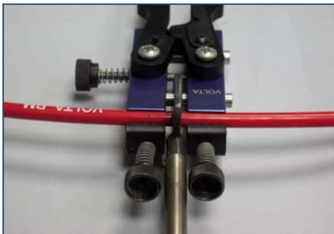
Зажим R-8 (для сварки ремней малого сечения)
